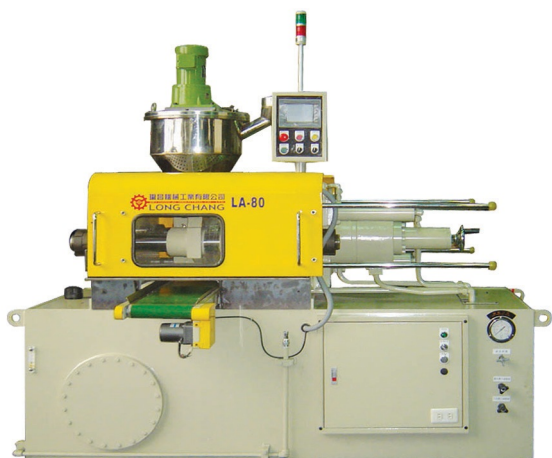
دستگاه خودکار شکل دهی پودر جهت شکل دهی پودر ملامین، اوره، فنل و دیگر مواد.
